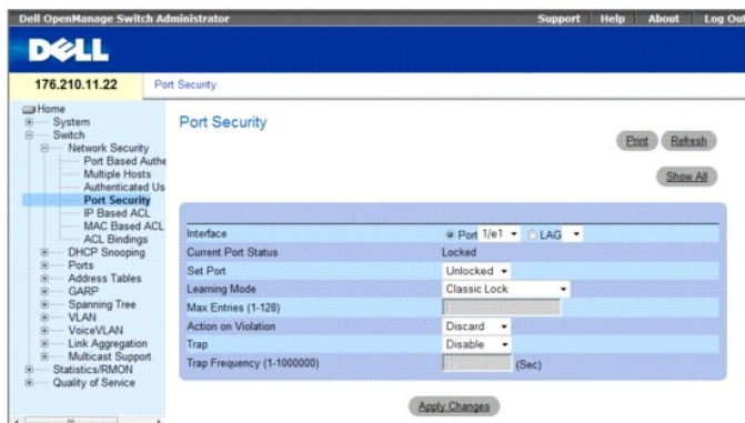
Рис. 7-7. Страница Port Security (Безопасность портов)
