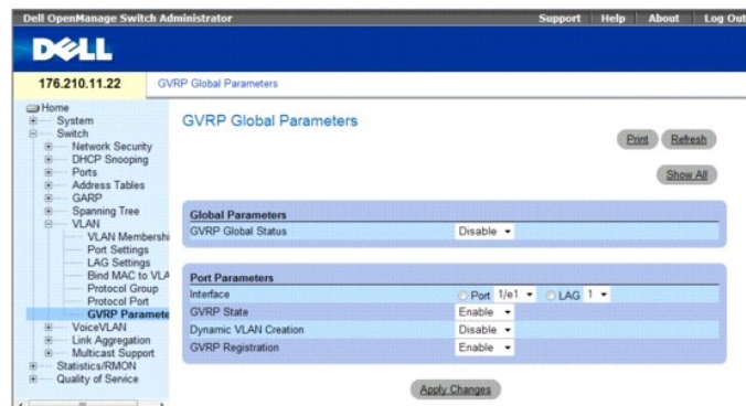
Рис. 7-60. Страница GVRP Global Parameters (Общие параметры GVRP)
